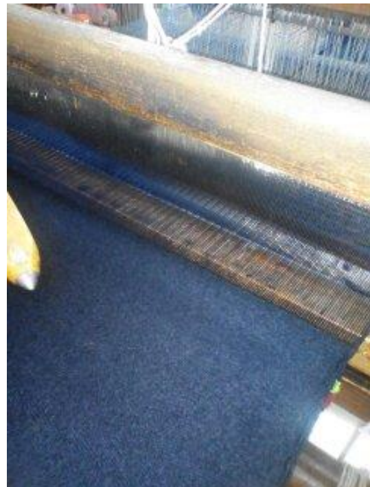
Il. 40. Proces tkania na Krośnie Nicielnicowym
