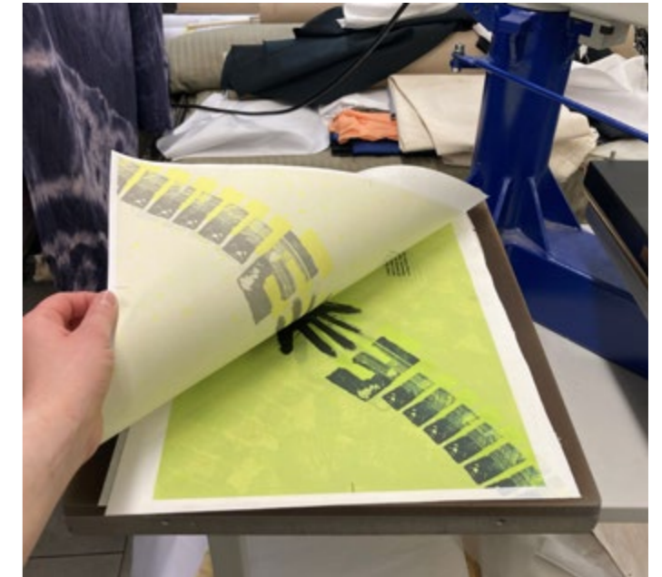
Il. 61: Proces wygrzewania druków na tkaninie (mikrofibrze) za pomocą termoprasy
