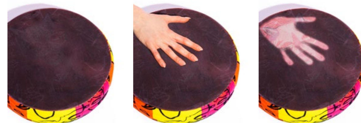
Il. 129: Sześć „Pastylek” pokrytych farbą termochromową. Zdjęcie pokazuje reakcję po dotknięciu ciepłą dłonią
