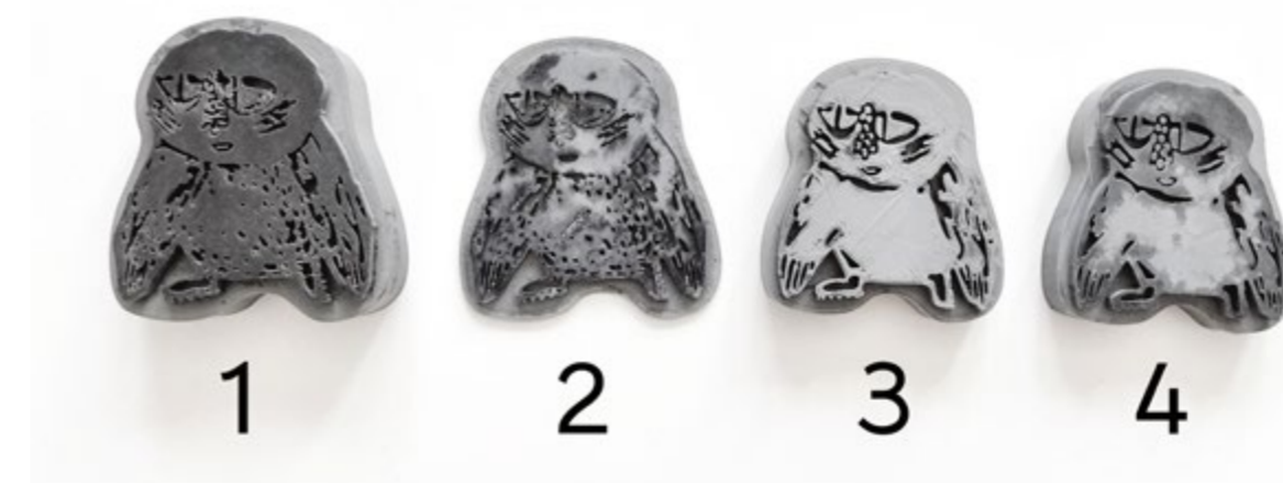
Il. 71: Kilka przykładowych prób wydruków z użyciem filamentów PLA i PET-G
