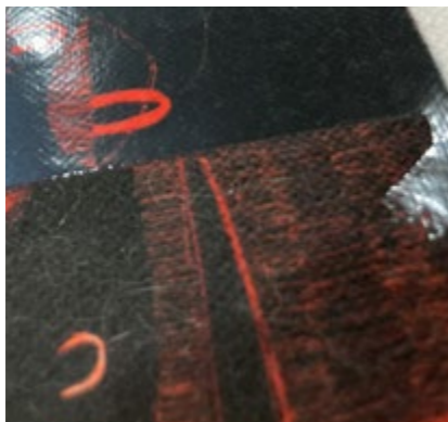
Il. 54: Folia Digital Extra Clear Gloss po wgrzaniu w zadrukowaną cyfrowo tkaninę
