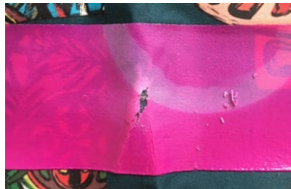
Il. 53: Próbką różowej farby termochromowej. Baza okazała się nieodpowiednio dobrana do tkaniny, co skutkowało kruszeniem się farby na zgięciach
