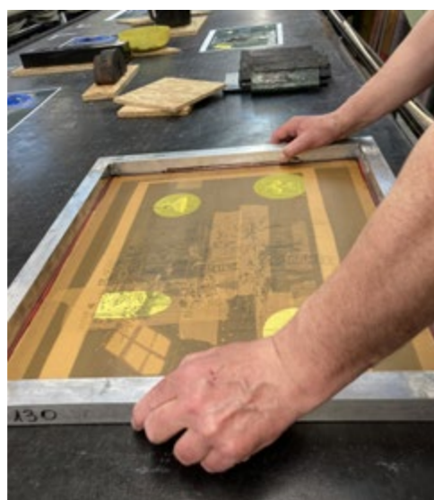
Il. 64: Proces nakładania farby termochromowej metodą sitodruku
